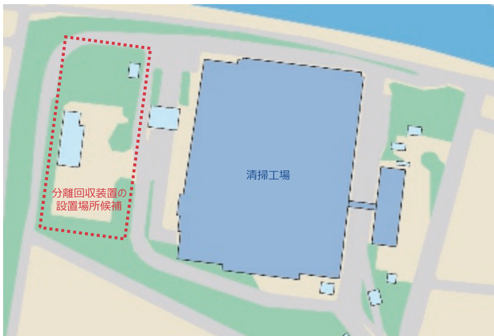
図表3-18 清掃工場へのCO 2 分離・回収装置導入検討イメージ (分離・回収装置の設置に十分な敷地を確保できる場合：赤枠が利用可能な面積)
